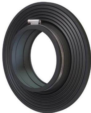
**Гидроизолирующий воротник** – это наиболее простое, доступное и, в то же время, эффективное решение по гидростатической изоляции в местах прокладки труб при заливке фундаментов, устройстве стен и перекрытий, проходах труб через колодцы. Способ применения – монтаж (*бетонирование*) рабочей трубы или гильзы с установленным на них Гидроворотником.
