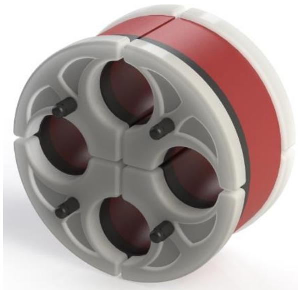
Уплотнитель GNK RS-P (разборный) предназначен для герметизации проходов кабелей электрических и телекоммуникационных систем при ремонте и реконструкции. Изготавливается под заказ, в зависимости от размеров и количества отверстий. Фланцы уплотнителя изготовлены из диэлектрического пластика, поэтому идеально подходит для герметизации различных кабелей. Применяется во всех областях промышленного и гражданского строительства.
